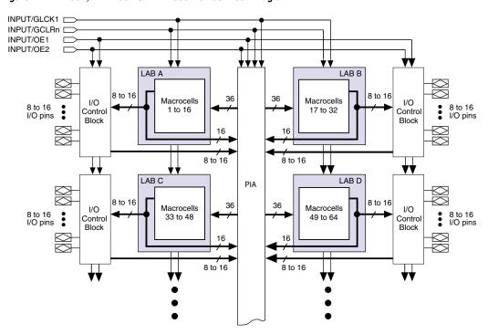
Figure 1. EPM7032, EPM7064 & EPM7096 Device Block Diagram
