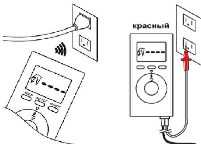
Измерительные провода мультиметров выполнены несъемными, что исключает их утрату при эксплуатации.
