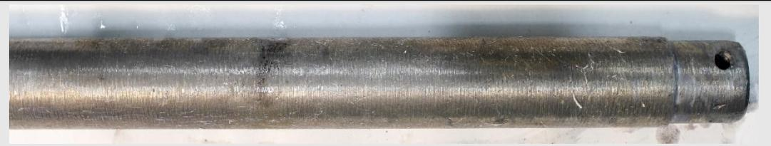
Отсутствуют следы продуктов коррозии. На поверхности тонкий слой пленки. Удаление продуктов реакции с помощью ветоши
