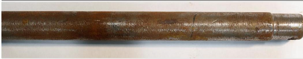
Заметны небольшие очаги коррозии. На поверхности присутствуют остатки смазывающих материалов. Нанесение распылением
