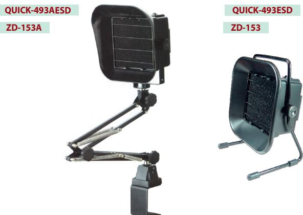
Дымопоглотители серии **QUICK-493** и **ZD** предназначены для поглощения и фильтрации вредных паров, возникающих при работе с флюсами, и состоят из мощного вентилятора и очистительного фильтра. Дымопоглотители крепятся к столу, их положение и угол наклона могут быть изменены посредством пантографного устройства арматуры.
