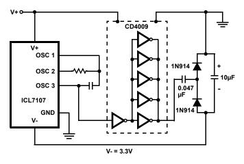
FIGURE 10. GENERATING NEGATIVE SUPPLY FROM +5V
