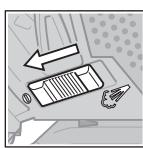
Изключване на приспособлението за издухване на стружки: За дейности в метал, както и при свързана аспирация преместете превключвателя (9) по посока на режещия диск.
