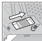
Вклучување на уредот за оддувување на струготини: За работење со многу струготини во дрво, пластика и сл. свртете го прекинувачот (9) во правец на мазниците за всисување.
